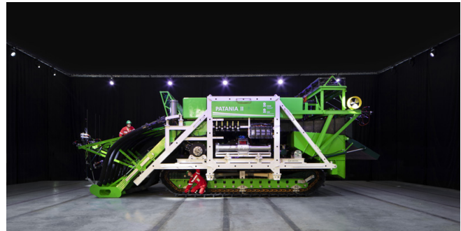
Abb. 1: Testkollektor Patania II der Belgischen Firma DEME-GSR, dessen Funktionalitäten im Frühling 2019 im belgischen und im deutschen Lizenzgebiet getestet werden. Bild: © DEME-GSR
