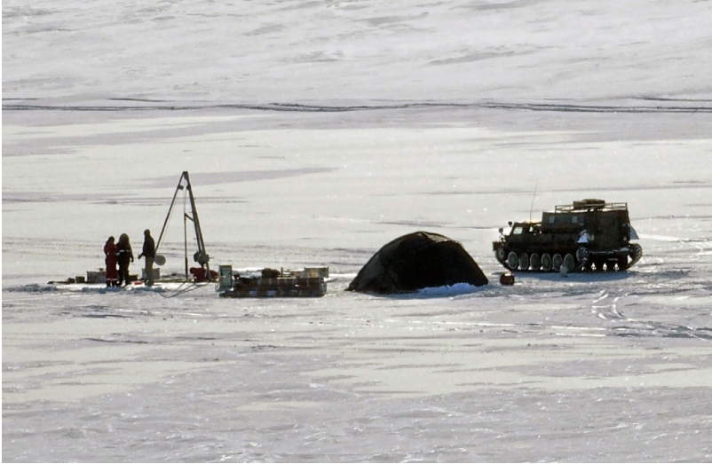
Abb. 3: Bohrcamp an der Küste der Laptewsee. In Kooperation zwischen dem Alfred-Wegener-Institut (AWI), dem Deutschen GeoForschungsZentrum (GFZ) und russischen Kollegen zum Beispiel aus Novosibirsk und Jakutsk wurden im April 2017 subaquatische Permafrost-sedimente gewonnen, um daran u.a. mikrobiologische Studien durchzuführen. Bild: Jan Axel Kitte / GFZ
