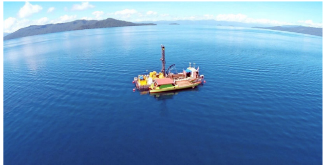
Abb. 1: Luftbild der Bohrplattform auf dem „Lake Towuti“. Das Versorgungsschiff wird benötigt um alle 12 Stunden den Wechsel der Mannschaft zu ermöglichen und die erbohrten Kerne an Land zu bringen.
